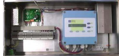
模块式组合由近红外传感器和评估分析仪组成。两者之间用光导纤维线连接。
